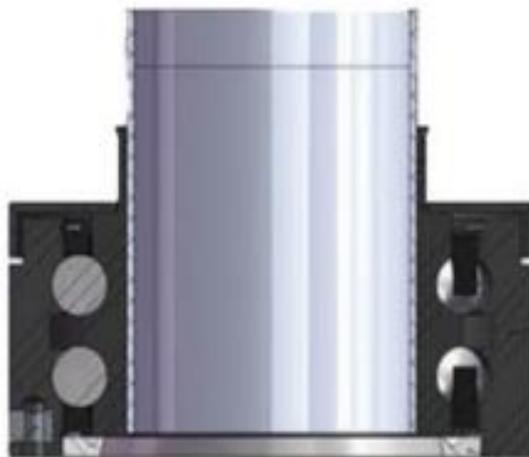
Рисунок 3 – Шарнирный узел вращающегося патрубка
